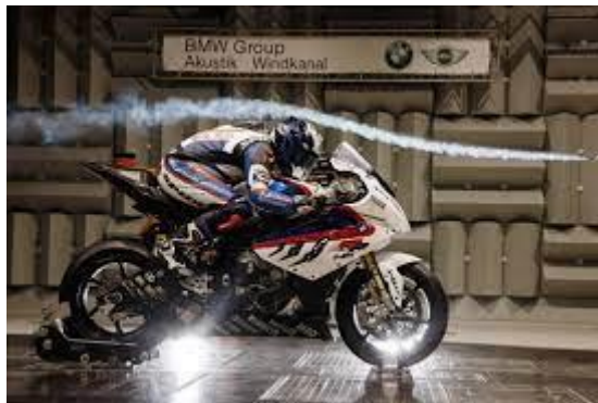
Ilustración 1 – Moto en posición de menor resistencia al aire [1]
