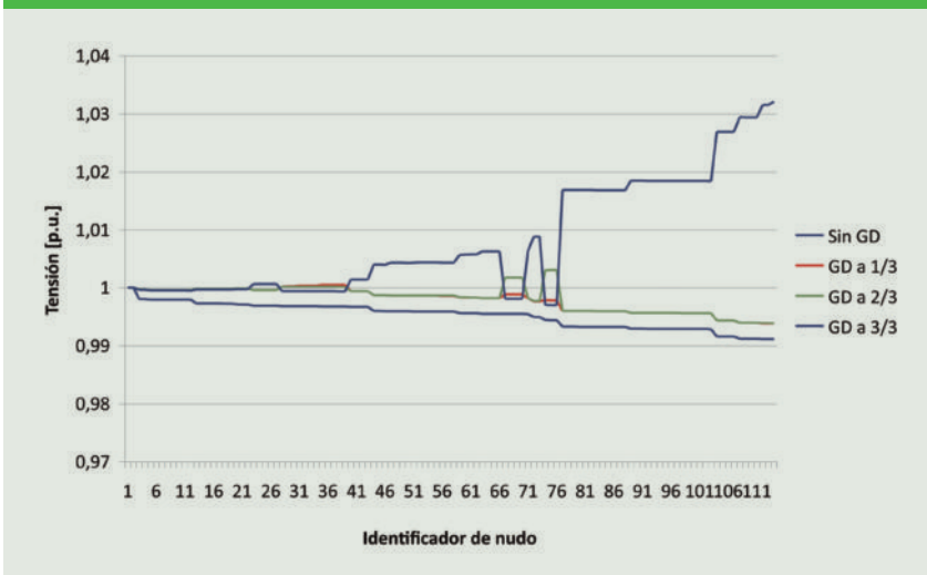
Figura 7. Variación de la tensión en función de la localización de la GD en una red media tensión
