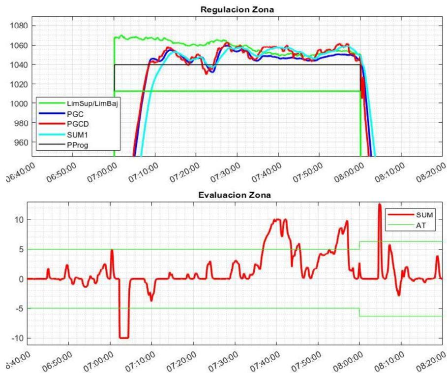
Figura 9. Detalle funcionamiento de la zona de regulación en la hora 7. Escenario máxima regulación eólica (98%). Día 1.
