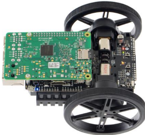
Figura 3.5. Vehículo basado en el kit de robótica Balboa 32U4 de la empresa Pololu
