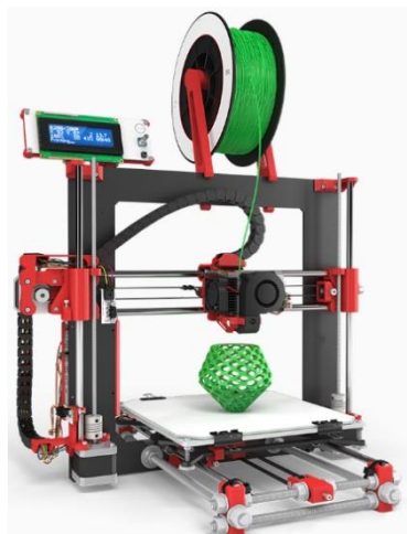
Ilustración 9: Impresión mediante extrusión de material [Özel, 2017]
