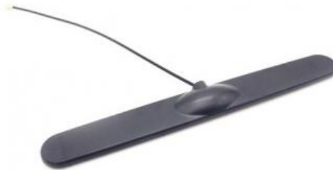
Figura 6. Imagen de la antena dipolo usada para aumentar el alcance de la comunicación
