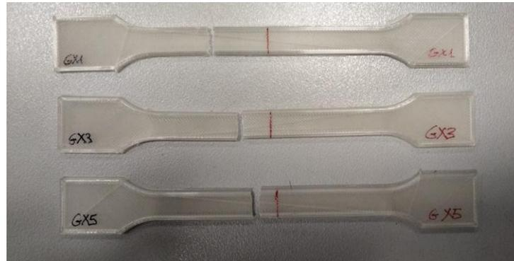
*Ilustración 36: ejemplo de probetas ensayadas a tracción*
