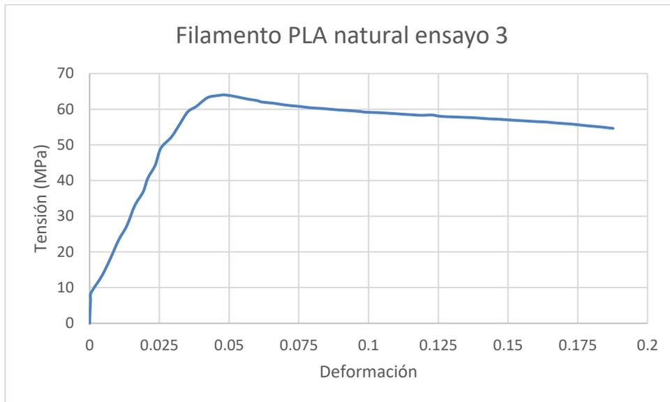
*Ilustración 59: ensayo de tracción de filamento PLA Basic sin degradación 3*
