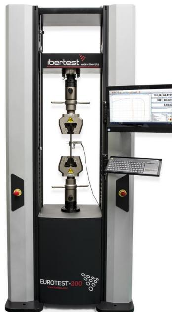
*Ilustración 37: máquina de ensayos Ibertest Eurotest 200 [47]*
