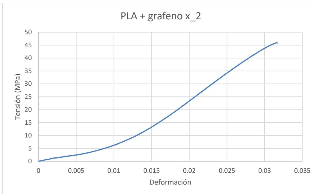
*Ilustración 111: Ensayo de tracción 1A-H.2 PLA reforzado con grafeno*
