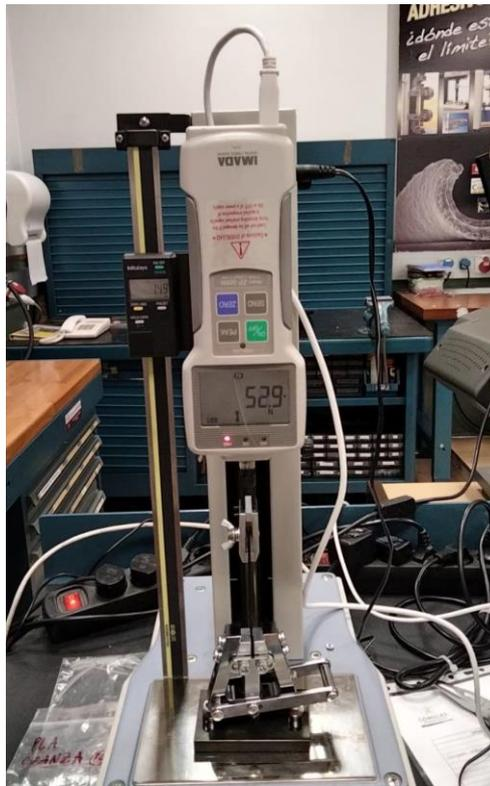
*Ilustración 31: ejemplo de ensayo de tracción de filamento con la máquina IMADA*
