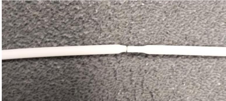
*Ilustración 46: rotura elástica del filamento 2 PLA Basic*
