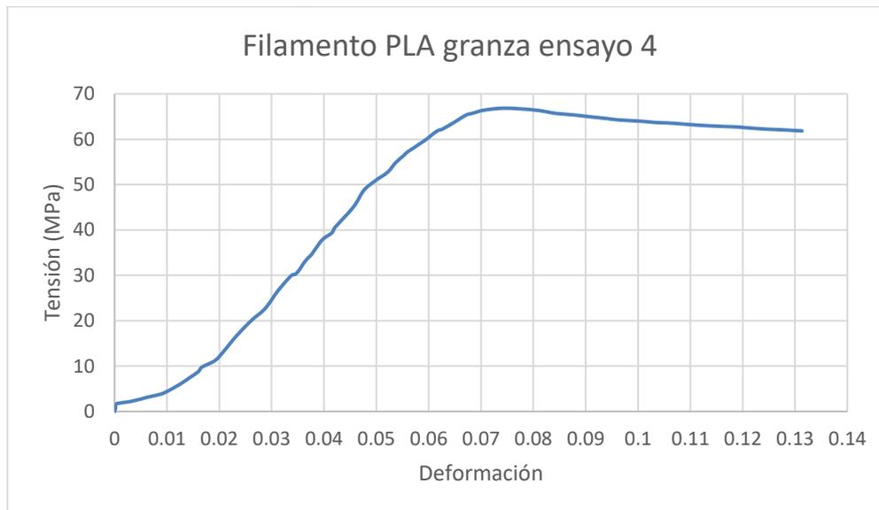
*Ilustración 70: ensayo de tracción de filamento PLA Granulate sin degradación 4*
