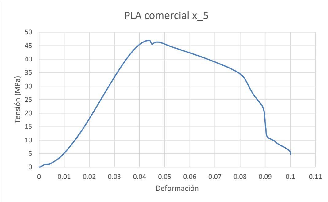
*Ilustración 97: Ensayo de tracción 1A-H.5 PLA Basic*
