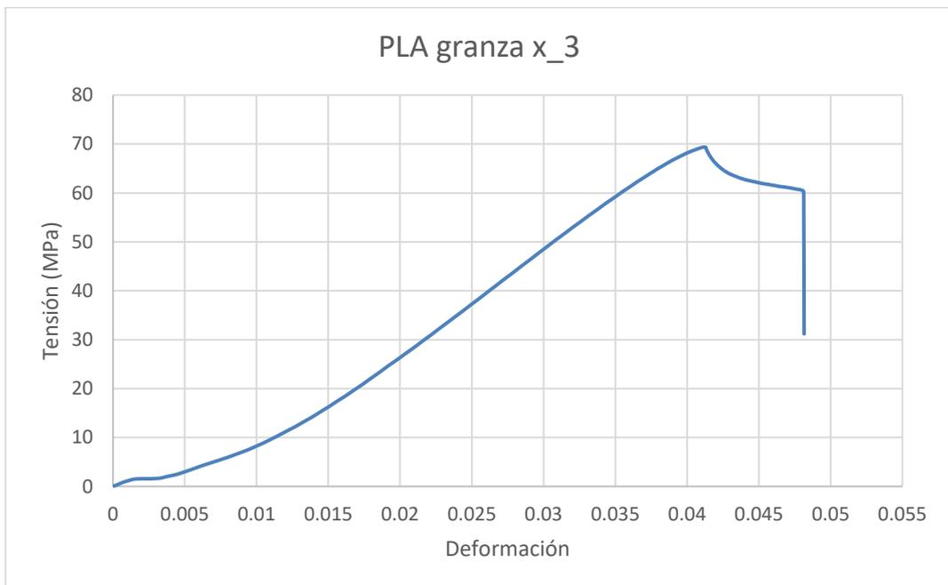
Ilustración 107: Ensayo de tracción 1A-H.3 PLA Granulate
