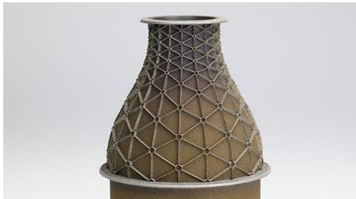
*Ilustración 18: ejemplo de impresión por deposición de energía directa [12]*
