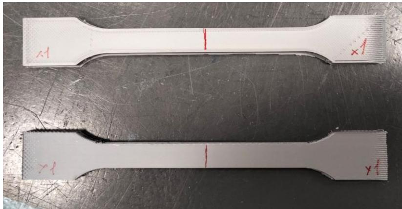
*Ilustración 53: probetas con magulladuras en los extremos*
