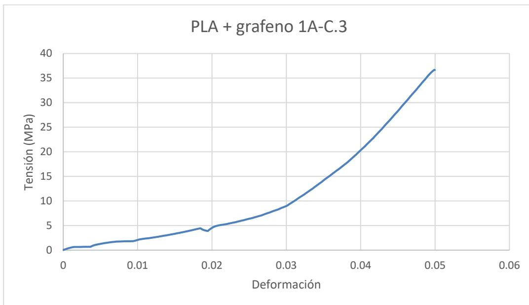
*Ilustración 115: Ensayo de tracción 1A-C.3 PLA reforzado con grafeno*
