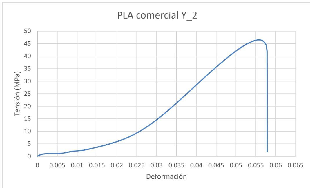
*Ilustración 100: Ensayo de tracción 1A-C.2 PLA Basic*
