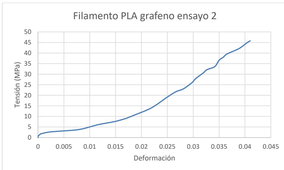
Ilustración 82: ensayo de tracción de filamento PLA reforzado con grafeno sin degradación 2
