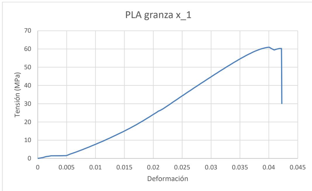
*Ilustración 105: Ensayo de tracción 1A-H.1 PLA Granulate*
