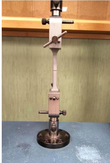
*Ilustración 52: mordazas utilizadas en el primer ensayo de tracción*
