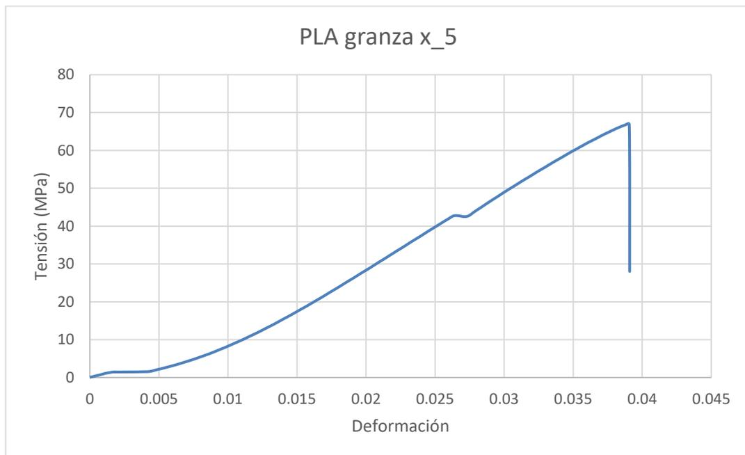
*Ilustración 109: Ensayo de tracción 1A-H.5 PLA Granulate*
