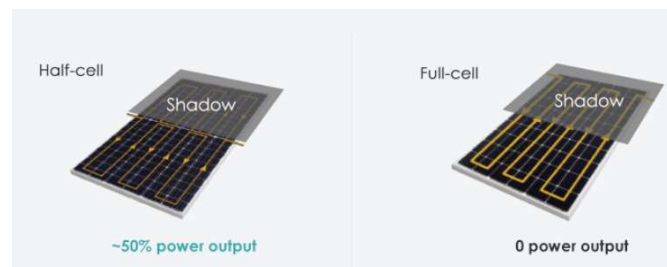
Ilustración 29 Comparativa de potencia entre Full Cell y Half Cell
