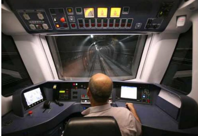
Figura 2.2: Conductor de metro manipulando la palanca del regulador de mando. (Fuente: [www.metromadrid.es](http://www.metromadrid.es))
