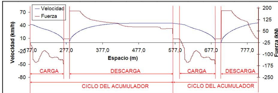
Figura 3.5: Perfil de velocidad y fuerza entre estaciones y ciclos de funcionamiento de los acumuladores
