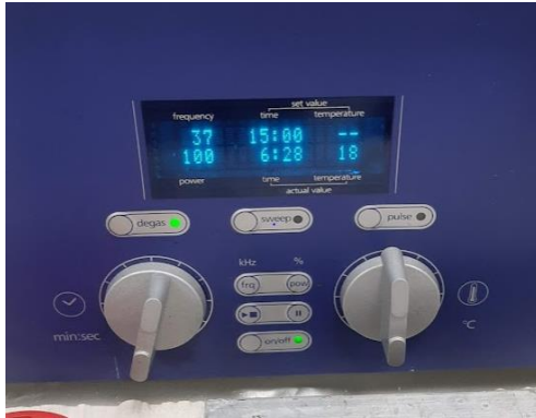
Figura 22: Configuración en modo Degas durante 15 minutos (izquierda) y vaso de precipitado lleno de mezcla con los plomos. Fuente: elaboración propia
