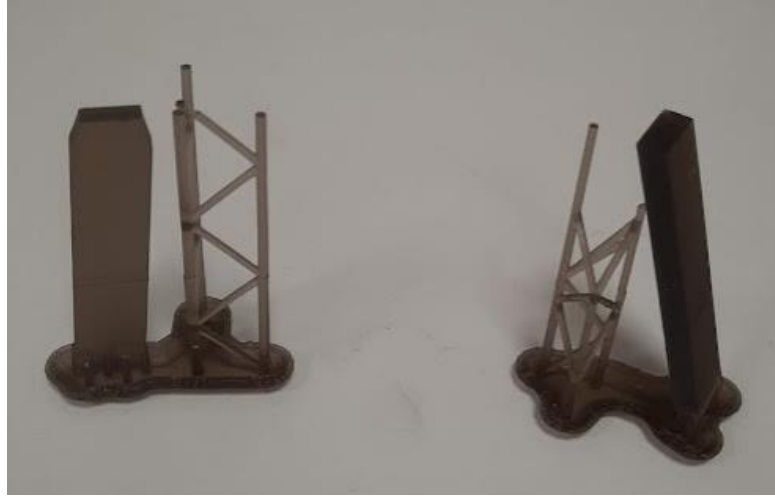
Figura 49: Probetas defectuosas debido a un paro en la impresión. Fuente: elaboración propia
