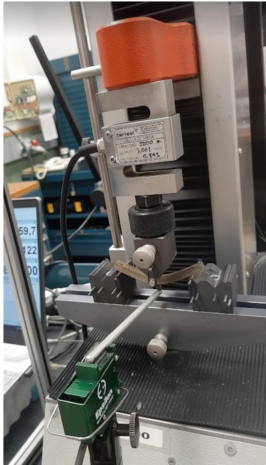
Figura 38: Flecha de flexión durante un ensayo. Fuente: elaboración propia
