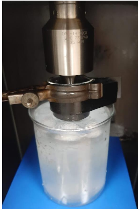
Figura 20: Conjunto punta-vaso de precipitación-refrigeración montado. Fuente: elaboración propia
