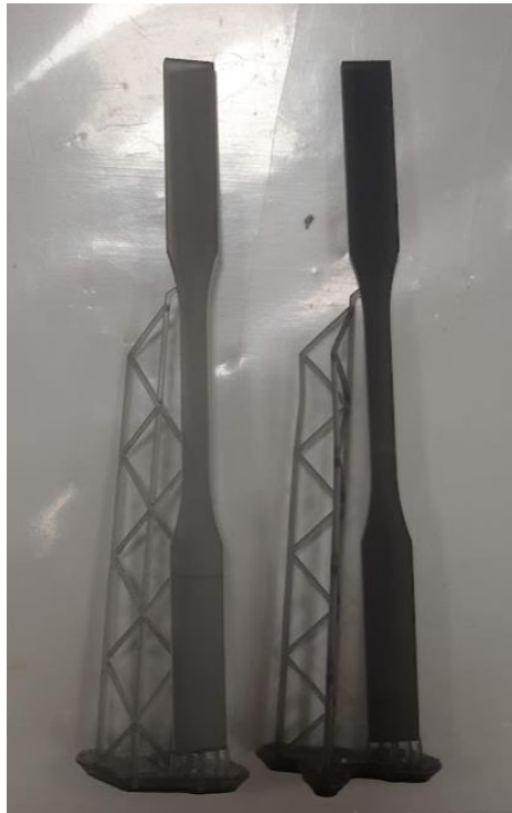
Figura 2: Probetas de fatiga con distintas concentraciones de grafeno silanizado (0,05% derecha y 0,01% izquierda). Fuente: elaboración propia
