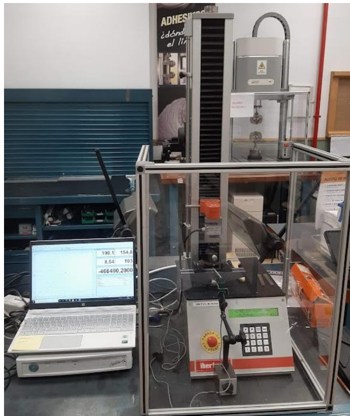
Figura 40: Ensayo de flexión en el laboratorio. Fuente: elaboración propia
