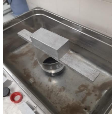
Figura 22: Configuración en modo Degas durante 15 minutos (izquierda) y vaso de precipitado lleno de mezcla con los plomos. Fuente: elaboración propia
