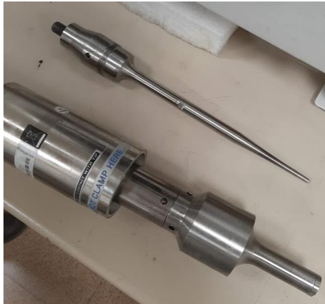
Figura 21: Comparación de tamaño y forma entre las dos puntas del sonicador: gorda (abajo) y fina (arriba). Fuente: elaboración propia
