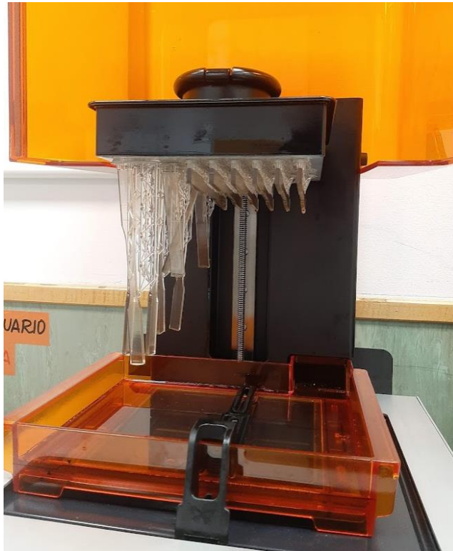
Figura 5: Impresión de probetas de fatiga finalizada. Fuente: elaboración propia
