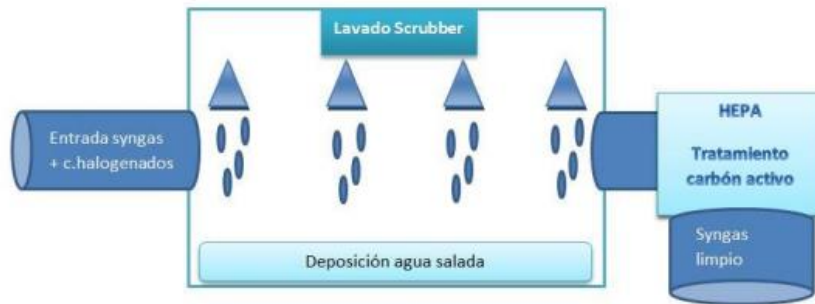
Figura 21. Esquema del sistema de neutralización (Valenciano López, 2015)
