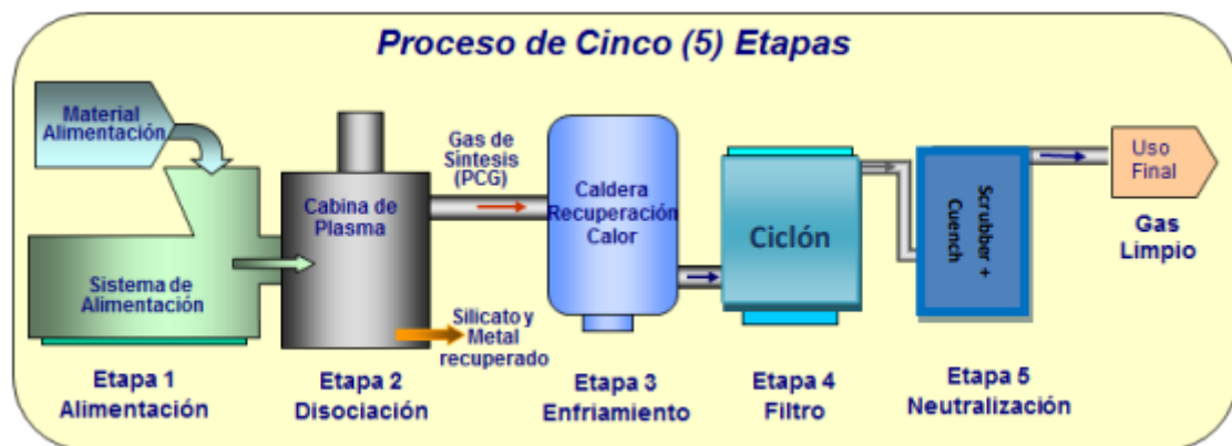
Figura 9. Etapas del proceso de gasificación por plasma (Valenciano López, 2015)
