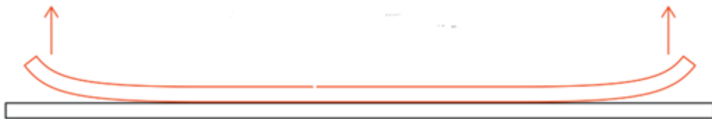
Figura 15. Warping de una pieza fabricada mediante FDM [27]
