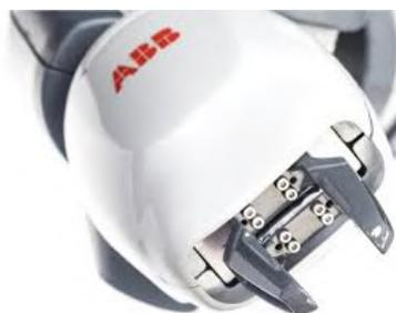
**Figura 58.** Pinza de agarre paralelo original del robot YuMi.
