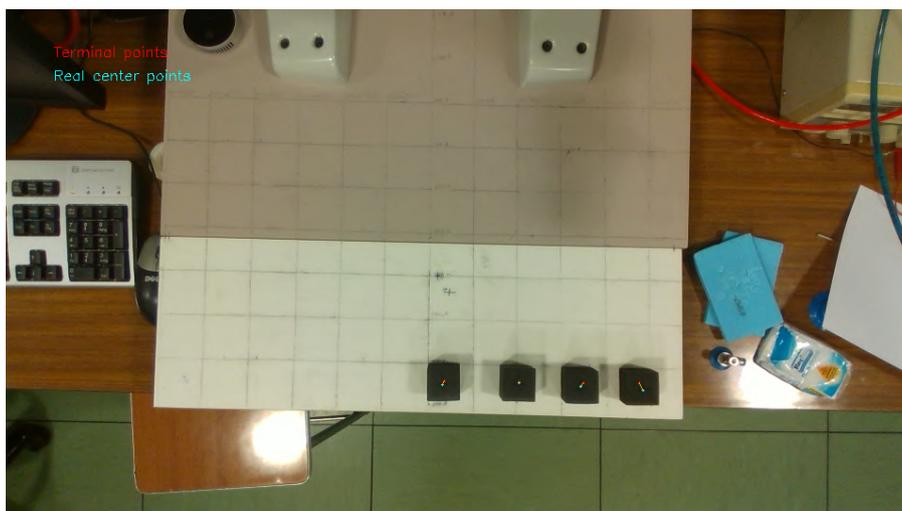
**Figura 36.** Visualización del error entre los centroides de las caras superiores de los cubos (en rojo) y los reales (en azul) para una coordenada  $y = 450 \text{ mm}$ .
