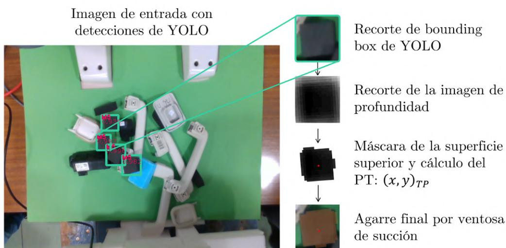
**Figura 62.** Proceso de cálculo del punto terminal  $(x, y, z)_{TP}$  para el agarre con ventosa.
