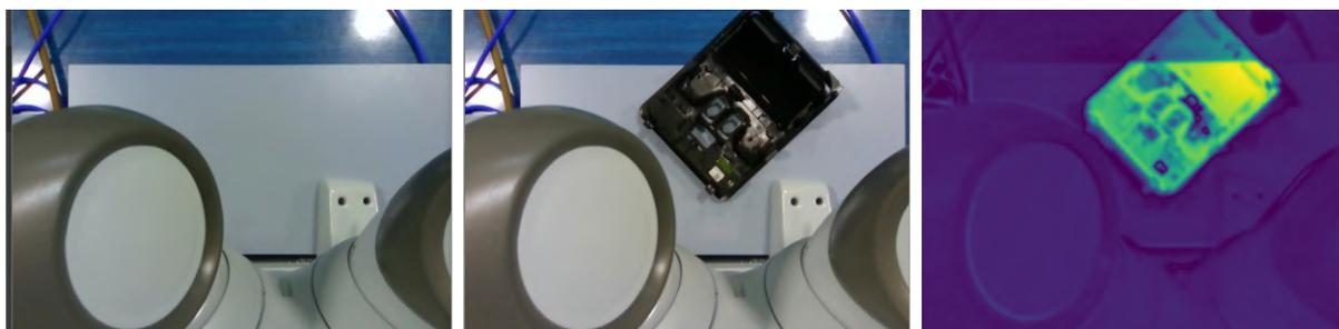
**Figura 44.** Primera parte del proceso de sustracción de fondo: imagen base, imagen con el objeto, y diferencia entre ambas imágenes.
