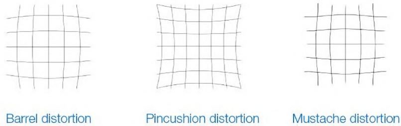
**Figura 27.** Ejemplos de distorsión radial en una imagen: de barril, de cojín y de bigote [Fri].
