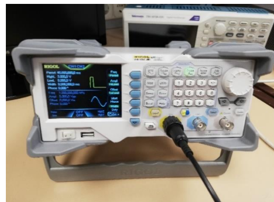
Figura 7: Conexión generador de señales
