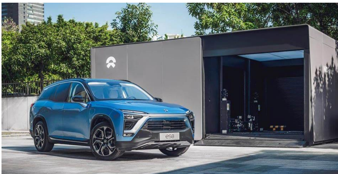
Ilustración 38: Intercambiador de Baterías de Ion-Litio de NIO, junto al modelo ES8 76 - Battery Swap Station
