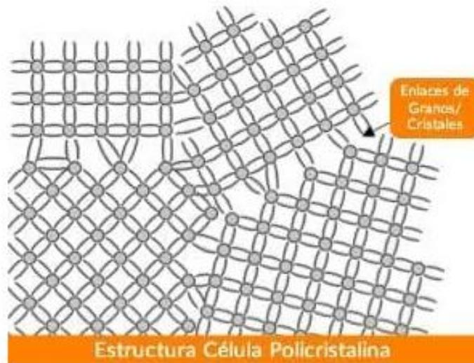
*Ilustración 21: Estructura interna de una célula policristalina*
