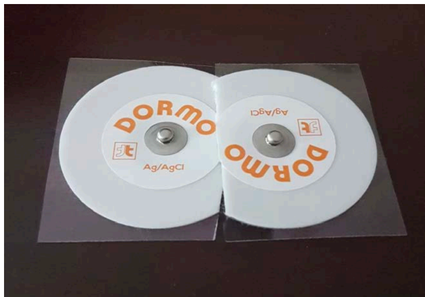
Ilustración 2. Electrodos de AgCl pre-gelificados menores de 10mm. Ilustración propia.
