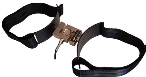
Imagen 3. Dinamómetro de la marca Chronojump Bosco System® utilizado para la recogida de los datos de fuerza.
