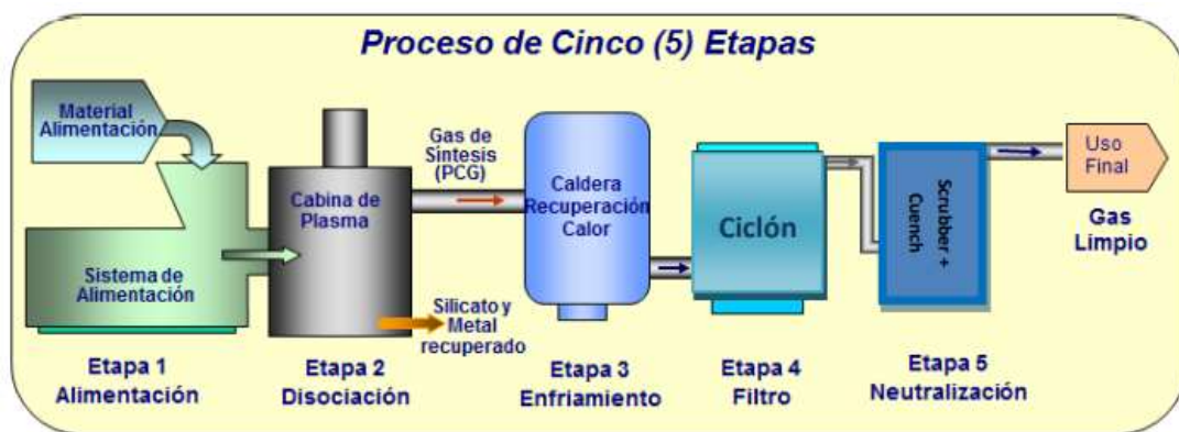
Ilustración 25: Etapas en la planta de gasificación [18]
