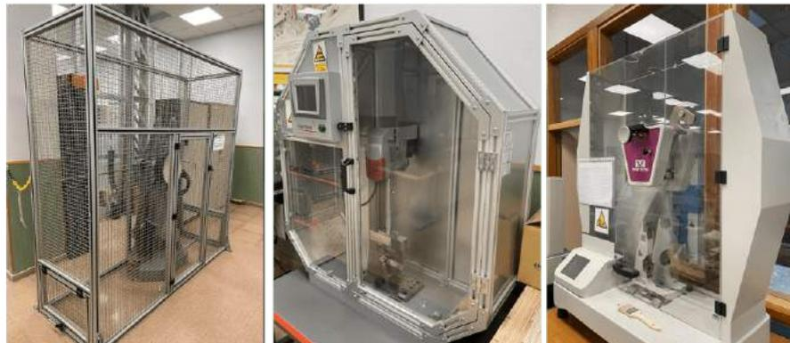
*Figura 5:* Péndulos Charpy para ensayo de impacto del laboratorio de materiales del ICAI
