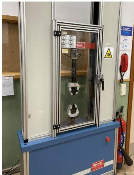
*Figura 4:* Fotografía de la máquina S.A.E. Ibertest ELIB 20 del laboratorio de materiales del ICAI
