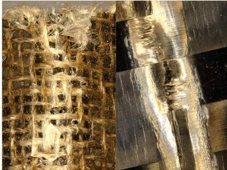
*Figura 31:* Imagen al microscopio de las fibras de lino y carbono
