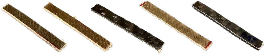
*Figura 24:* Probetas de impacto (80x10mm) de todas las combinaciones de materiales fabricadas
