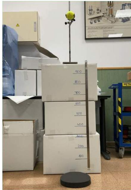
*Figura 6:* Ensayo del bote de una pelota sobre plancha de polietileno desde una distancia determinada
