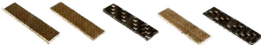
*Figura 23:* Probetas de flexión (60x15mm) de todas las combinaciones de materiales fabricadas
