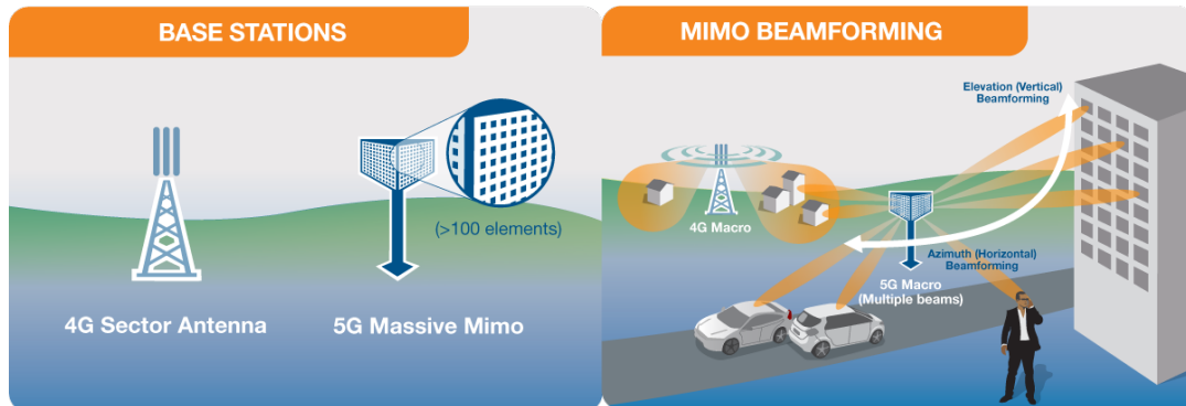
Ilustración 38: Esquema representativo de una antena MIMO masiva [77]
