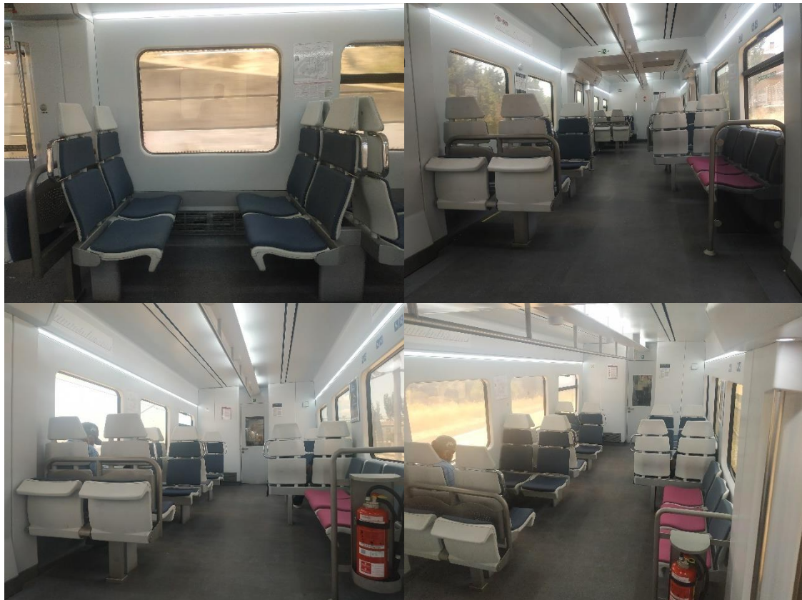
Figura 31. Distribución interior de asientos de la UT 446 de RENFE.
