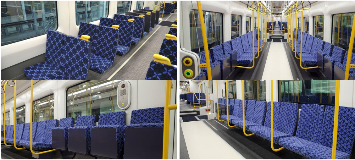
Figura 30. Distribución interior de asientos del Tren de Cercanías de CAF (Auckland, Nueva Zelanda) [10].
