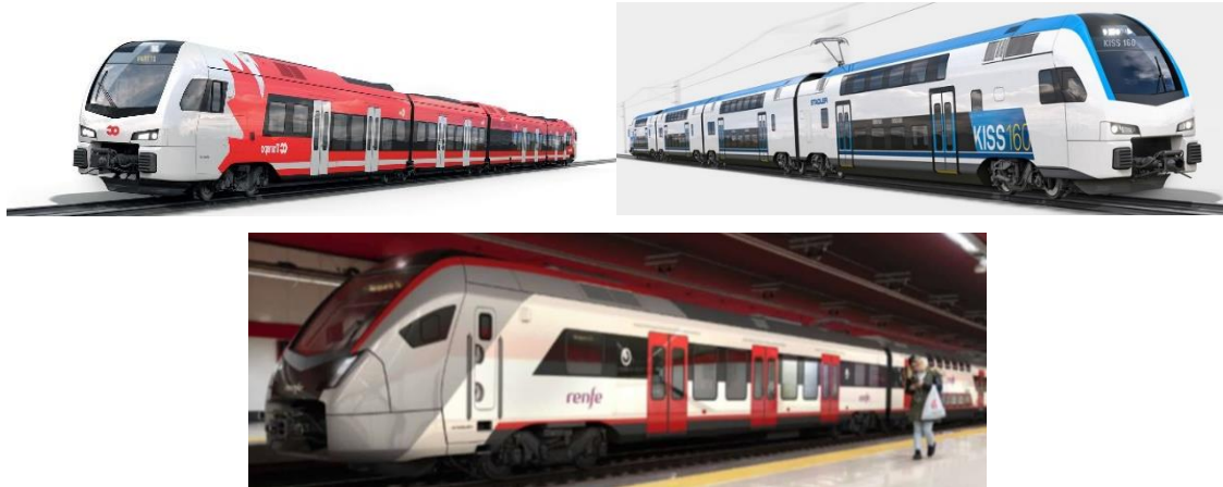
Figura 25. Trenes de 1 piso, 2 pisos y mixtos [6].
