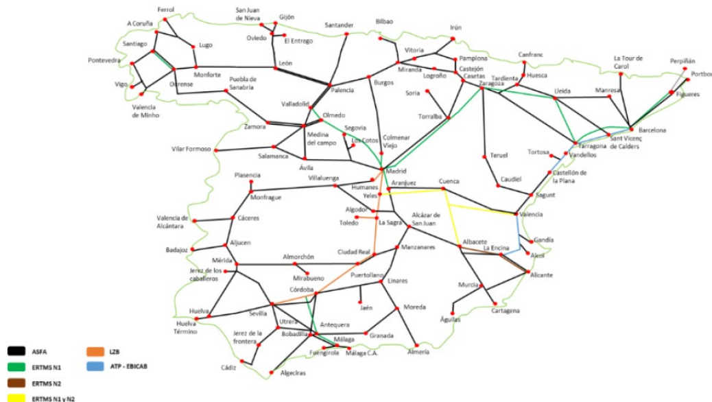
Imagen 2: Mapa geográfico de los Sistemas de Señalización Instalados por Líneas
