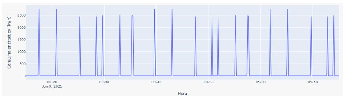
*Figura 22. Curva de carga de la plancha.*
