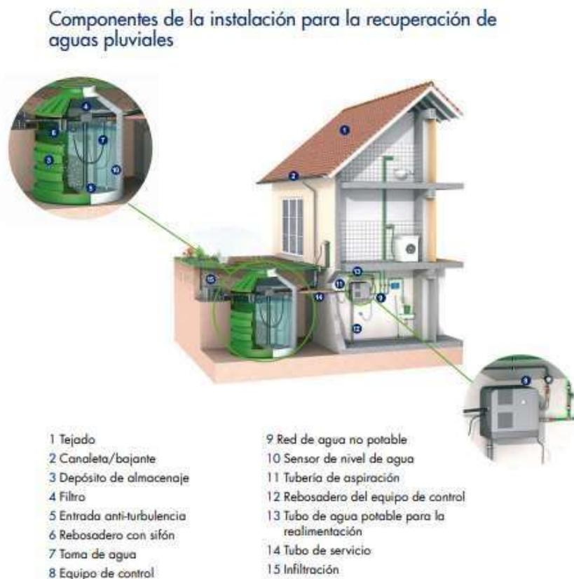
Imagen 21: Esquema de instalación estándar para la recuperación de aguas pluviales. Fuente: Guía Técnica para el Aprovechamiento de aguas pluviales
