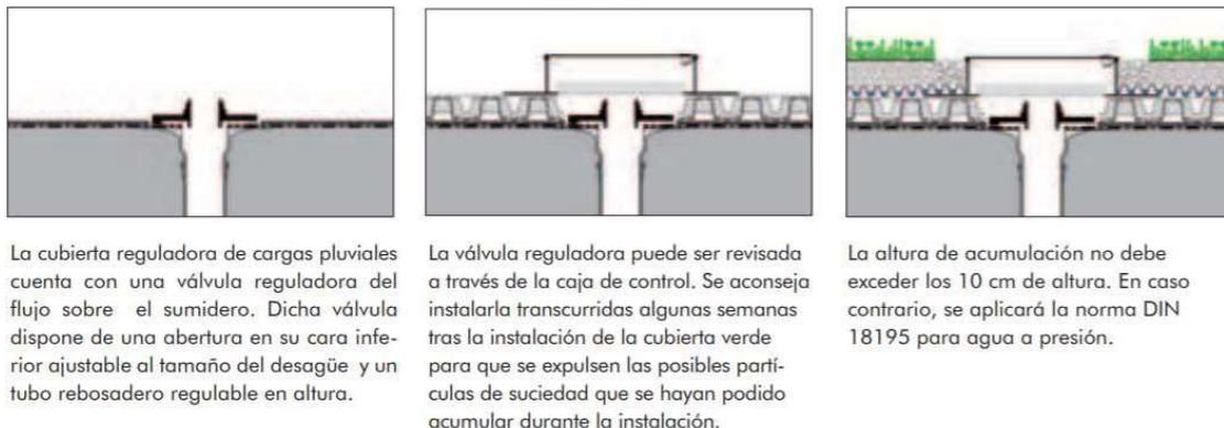
Imagen 23: Explicación del sistema de descarga de Zinco. Fuente: Zinco
