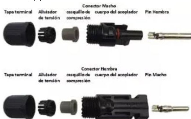
Ilustración 12. Conectores MC4 hembra y macho. [14]
