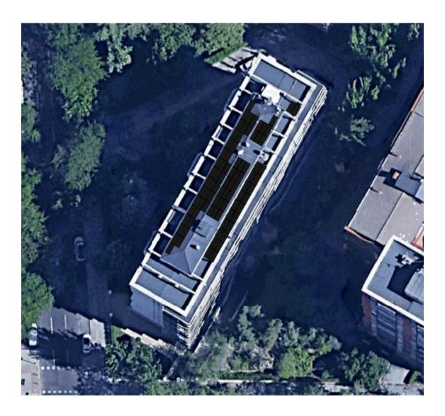
Figura 4. Imagen 2D de la disposición de los módulos en la cubierta del edificio, (Elaboración Propia).
