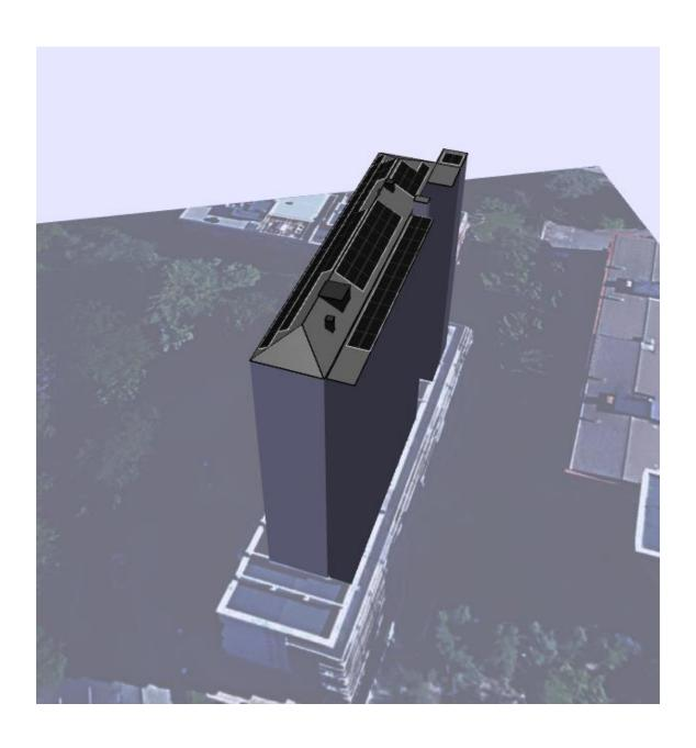
Figura 5. Imagen 3D de la disposición de los módulos en la cubierta del edificio. (Elaboración Propia)
