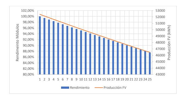
Figura 11. Decremento en el rendimiento y generación de la instalación.
