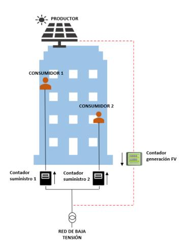
Figura 3. Esquema de conexión de la instalación de autoconsumo. (IDAE y Elaboración Propia)
