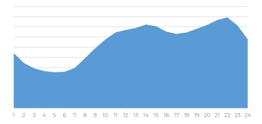
Figura 7. Perfil de demanda de un consumidor 2.0 TD, (REE y Elaboración Propia).
