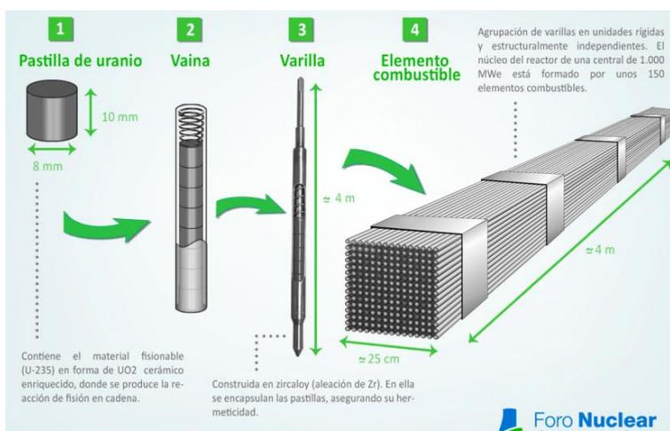
**Figura 2.** Fabricación de un elemento combustible [14][13].
