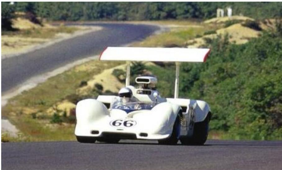
Imagen 7. Imagen del *Chaparral 2E* de 1966. Primer coche de competición en montar un alerón sobre las manguetas del eje trasero. [9]
