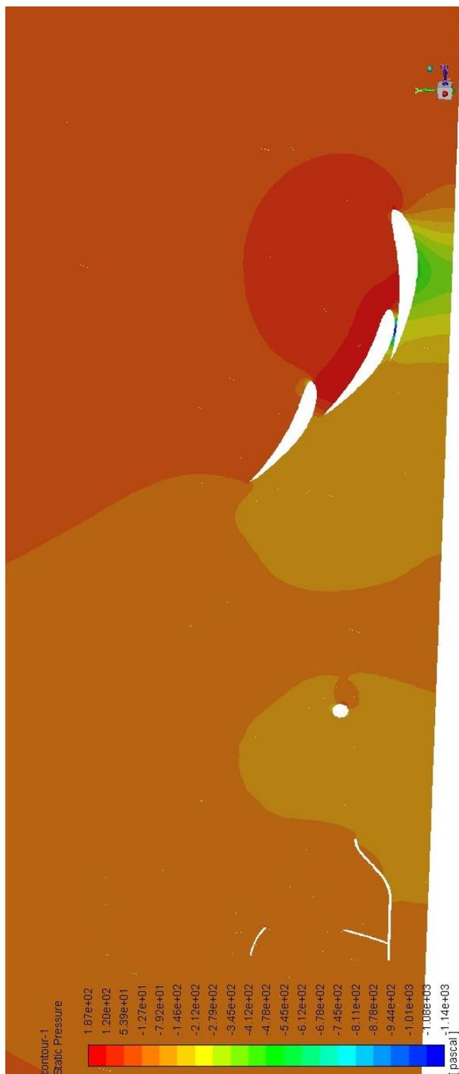
Imagen 39. Mapa de presión estática en un plano longitudinal que corta al alerón por la parte de tres elementos correspondiente a la geometría de 30°. Se aprecian los efectos de la estela del alerón y la estela de la rueda.
