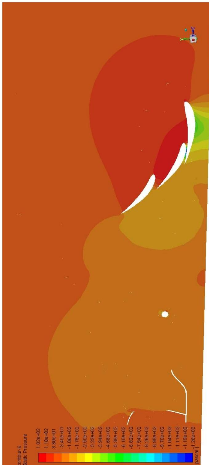
Imagen 42. Mapa de presión estática en un plano longitudinal que corta al alerón por la parte de tres elementos correspondiente a la geometría de 40°. Se aprecian los efectos de la estela del alerón y la estela de la rueda.
