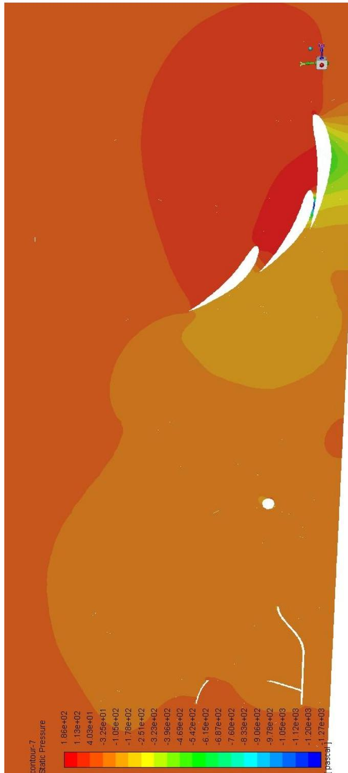
Imagen 45. Mapa de presión estática en un plano longitudinal que corta al alerón por la parte de tres elementos correspondiente a la geometría de 45°. Se aprecian los efectos de la estela del alerón y la estela de la rueda.
