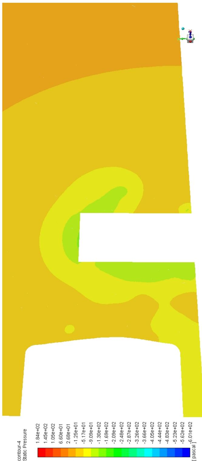
Imagen 25. Mapa de presión estática en un plano transversal a la geometría situado en la rueda del modelo. Se aprecia la depresión causada por el desprendimiento de capa límite alrededor de la rueda.
