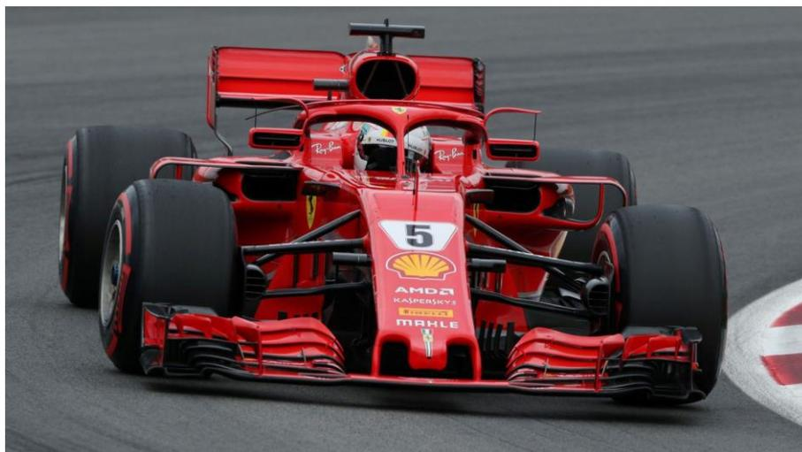
Imagen 9. Imagen del *Ferrari SF71H* de *Formula 1* de la temporada 2018. En él se puede ver un claro ejemplo de los alerones delanteros que montaban los equipos en aquel año, estos han sido, hasta la fecha, los más sofisticados en la historia de la categoría. [11]
