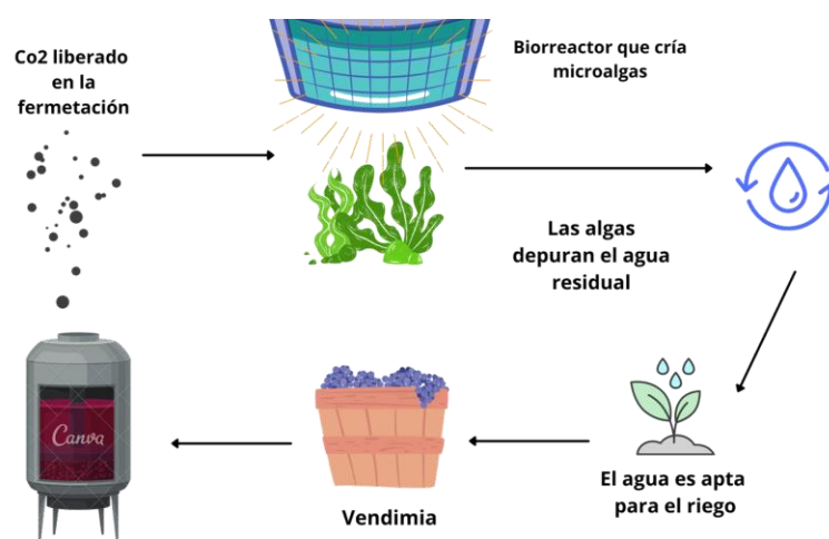
Figura 7: Esquema del sistema ZEWIPRO
