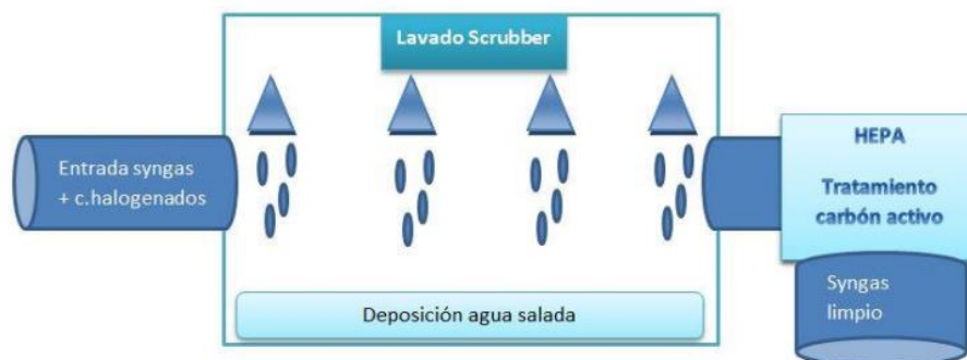
Figura 31. Esquema del funcionamiento del sistema de neutralizado [19]
