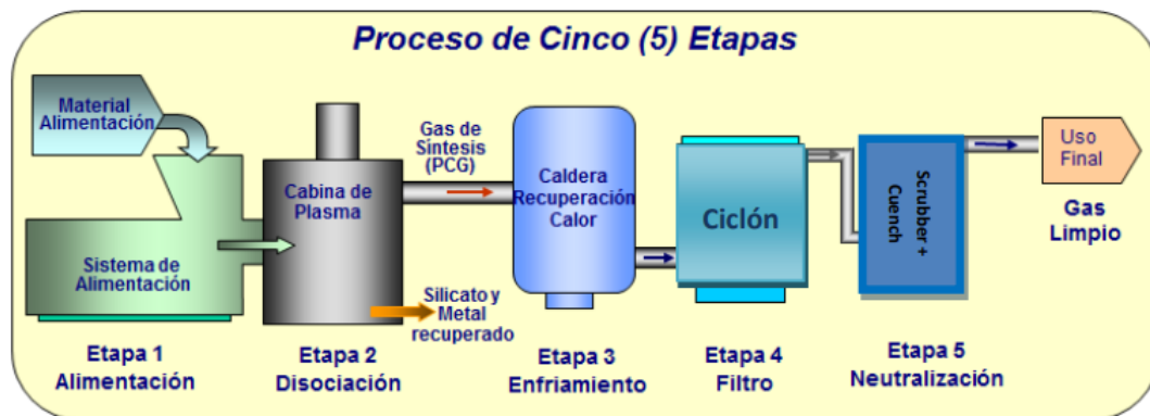
Figura 28. Etapas del proceso de gasificación por plasma [19]
