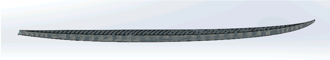
Ilustración 36. Vista Lateral del Ensamble de la Estructura de PLA y Capa de Fibra de Vidrio
