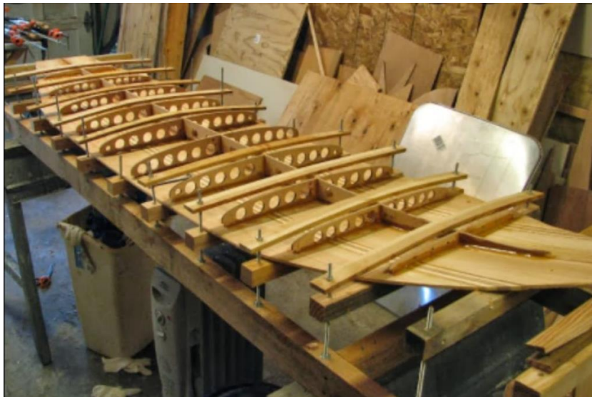
Ilustración 15. Ensamblaje de una Tabla de Surf Tradicional
