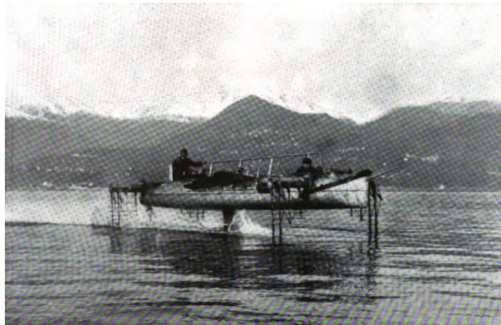
Figura 1. Hidroala fabricada por Enrico Forlanini en el lago Maggiore. (www.CampelloCharter.com)
