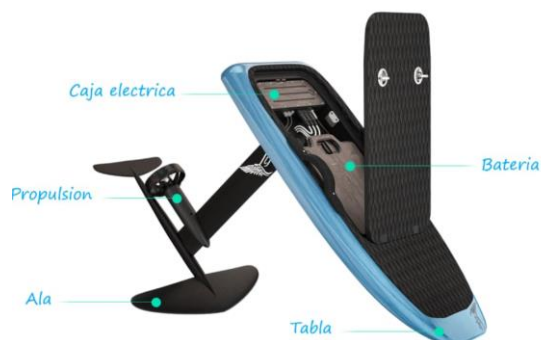
Figura 4. Componentes que conforman un eFoil. ( www.hydrofoil.net )
