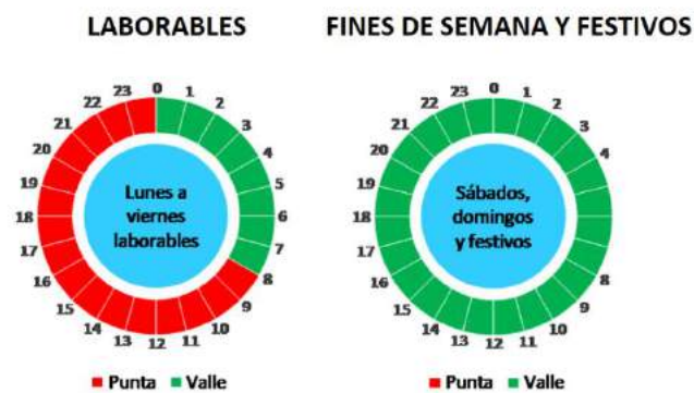
Ilustración 17: Periodificación potencia contratada 2.0 TD. Fuente: EnergiGreen.
