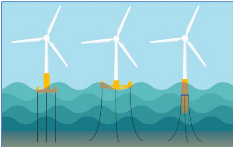
Figura 13: Tecnologías de eólica flotante. En orden: Plataforma de Apoyo en Tensión ((TLP), Plataforma Semi-sumergible, Spar. Fuente: MITECO
