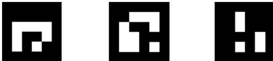
*Figura 3.2: Marcadores ArUco del diccionario `DICT_4x4_50`.*
