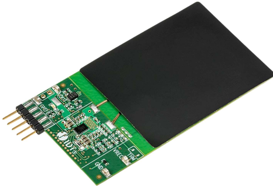
Figura 5.1.1 Microcircuitos P9221-R (Fuente: Renesas)
