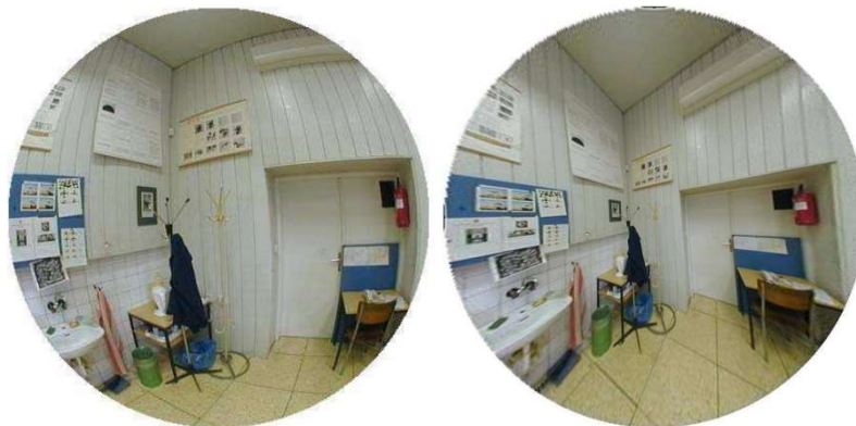
Figura 4.1.4 Distorsión radial (izquierda) y corrección (derecha) (Kukelova & Pajdla, 17-22 de junio de 2007)
