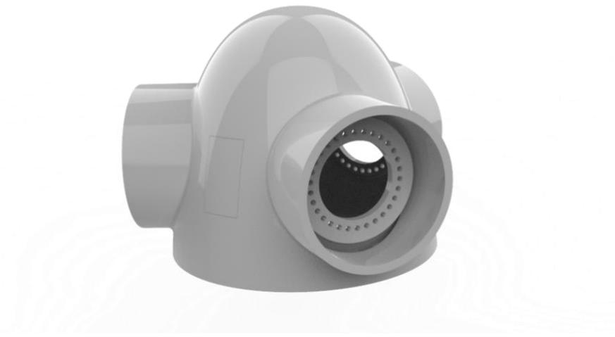
Ilustración 15: Modelo CAD de un buje. Fuente:GrabCad.
