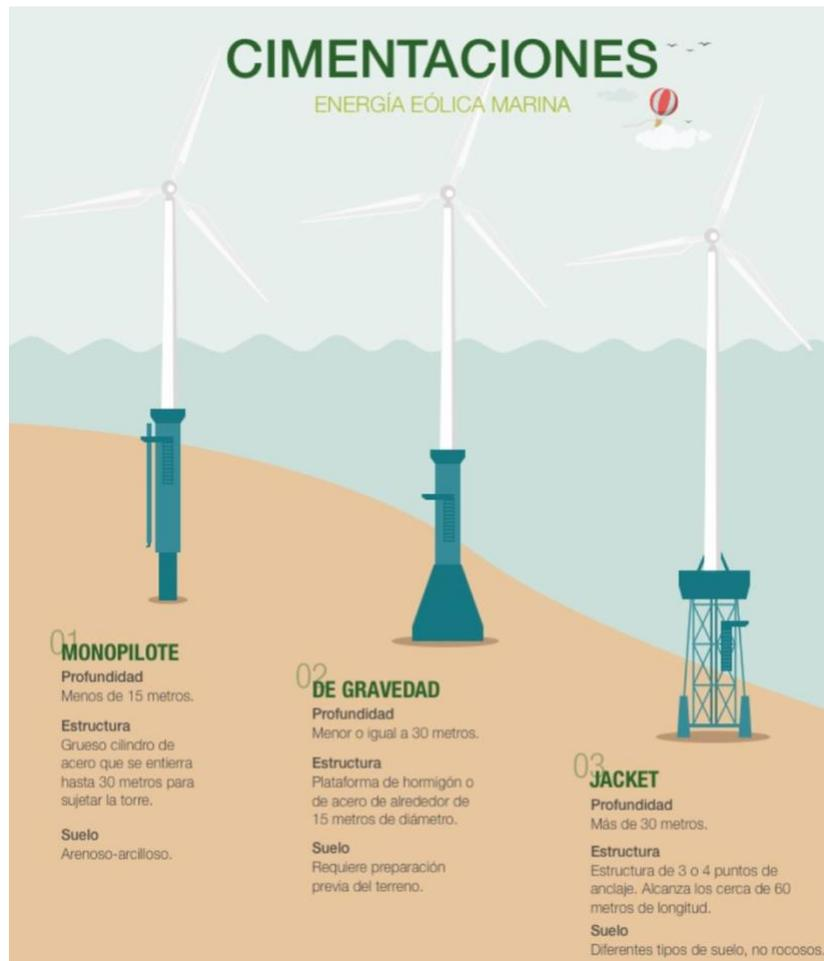
Ilustración 12: Tipos de cimentaciones. Fuente: Iberdrola.
