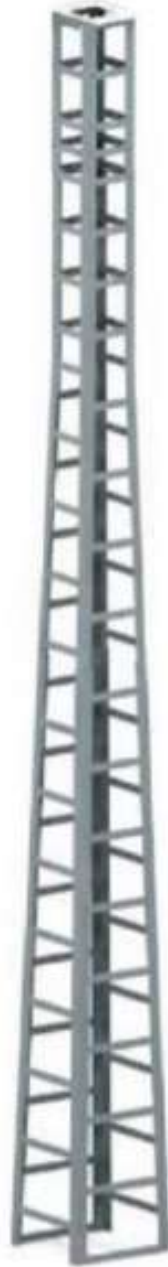
Figura 9.9: Torre Cuatripata de celosía de 18 metros
