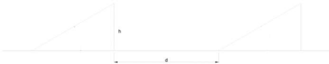
Figura C.8: Distancia entre filas de paneles solares
