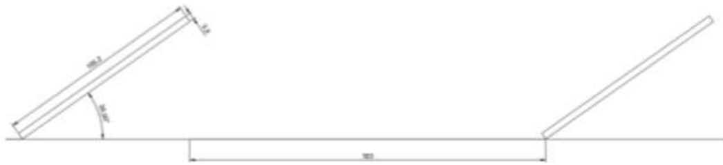
Figura 6.4: Perfil de la instalación solar
