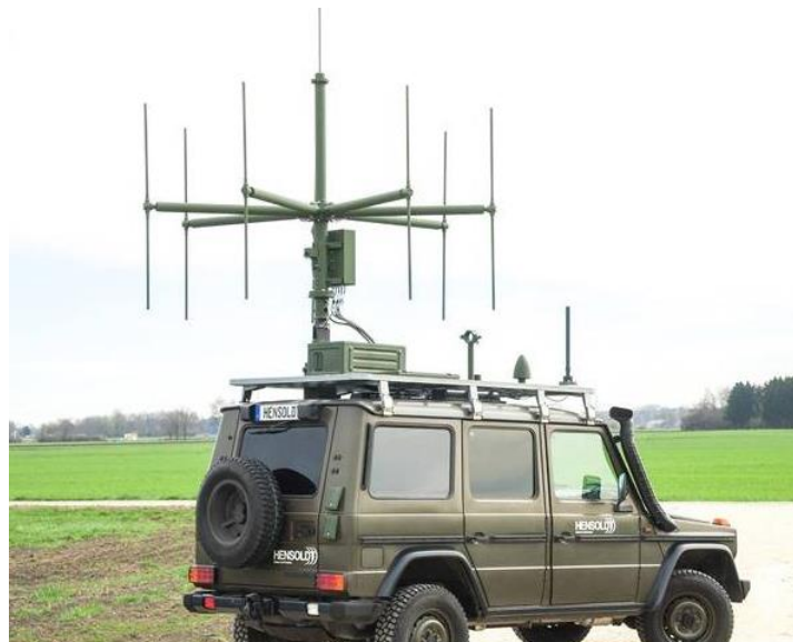
Ilustración 14 Despliegue radar pasivo HENSOLDT
