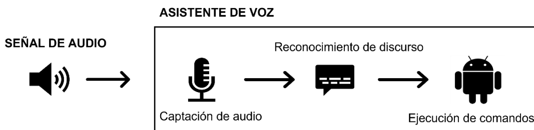
Ilustración 5. Subsistemas de un dispositivo asistente de voz
