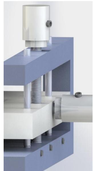
*Figura 22. Sujeción de varillas.*
