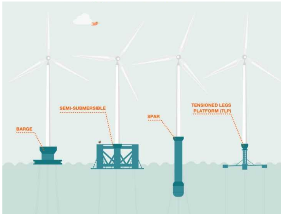
Figura 21. Estructuras flotantes más comunes (Iberdrola)
