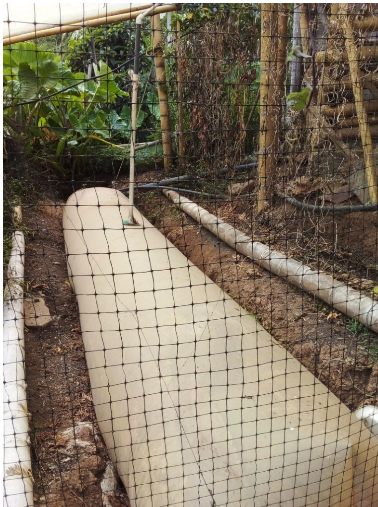
Figura 10: Biodigestor de plástico en un país subdesarrollado (Fuente: Investigación y experiencias de multiplicación en países tropicales- Proporcionado MMUU [3])
