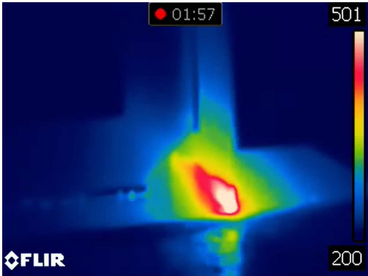
Ilustración 43: Ensayo térmico de un proceso de soldadura por electrodo revestido
