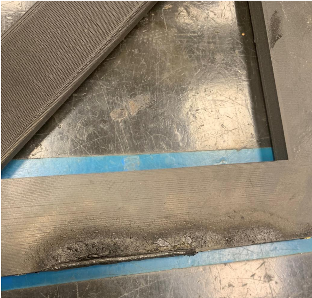
Ilustración 34: Lateral de la escuadra magnética tras el proceso de soldadura MIG
