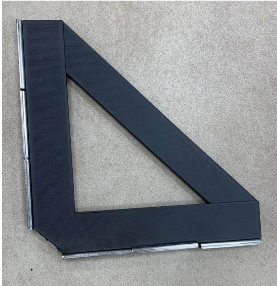
Ilustración 31: Escuadra magnética con imanes montados
