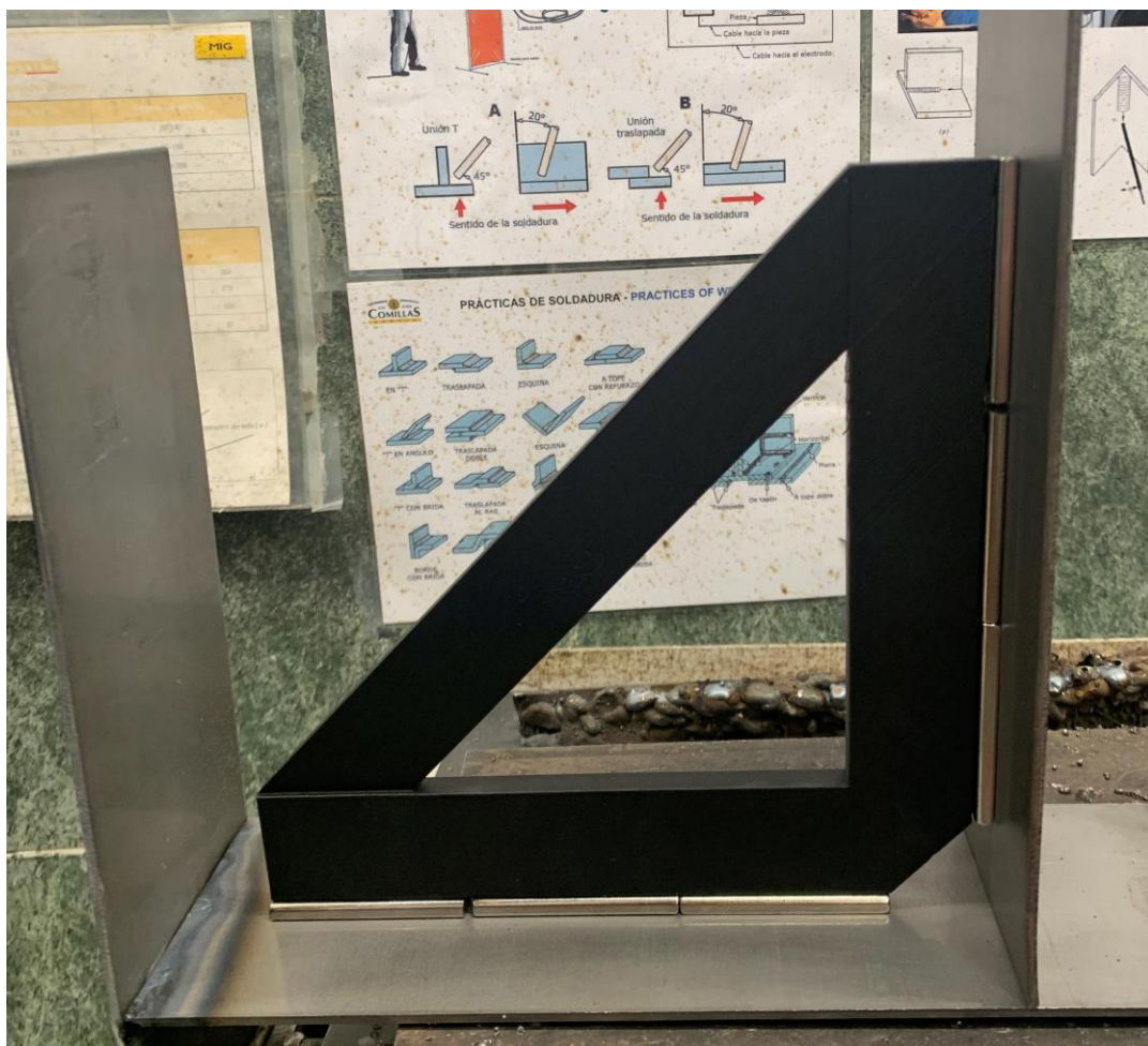
Ilustración 47: Montaje para la soldadura MIG
