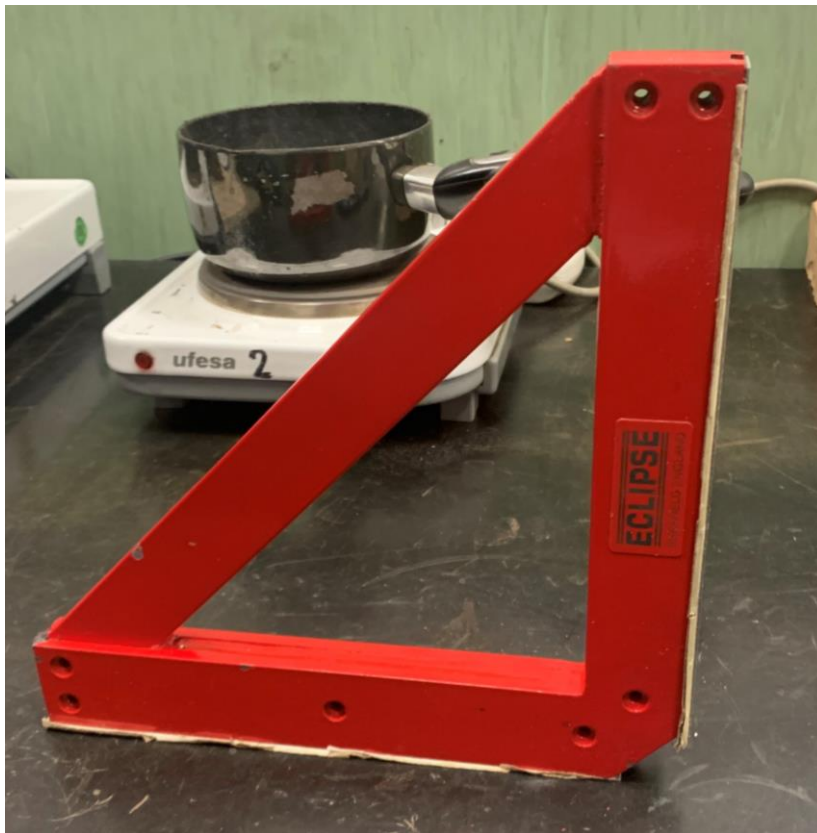
Ilustración 12: Escuadra magnética de soldadura
