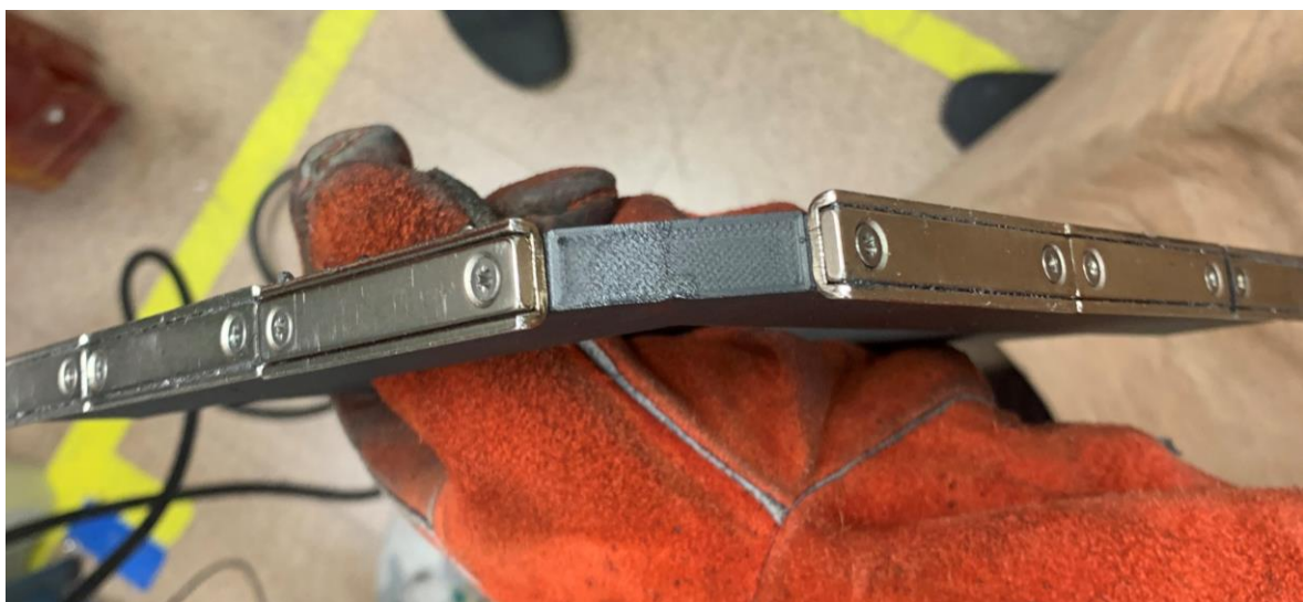
Ilustración 46: Escuadra magnética después del proceso de soldadura por electrodo revestido 2
