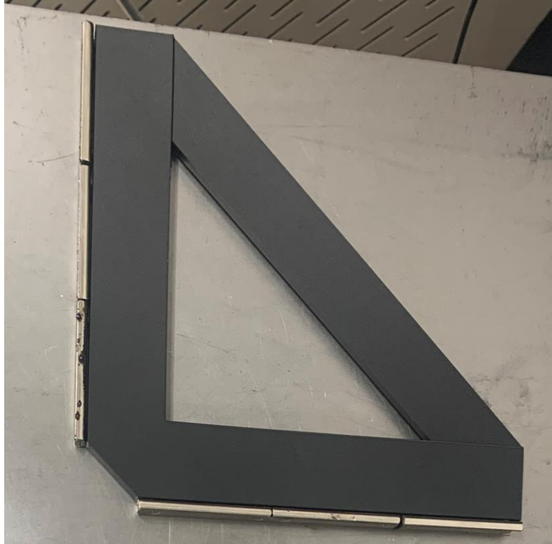
Figura 2 – Escuadra magnética fabricada
