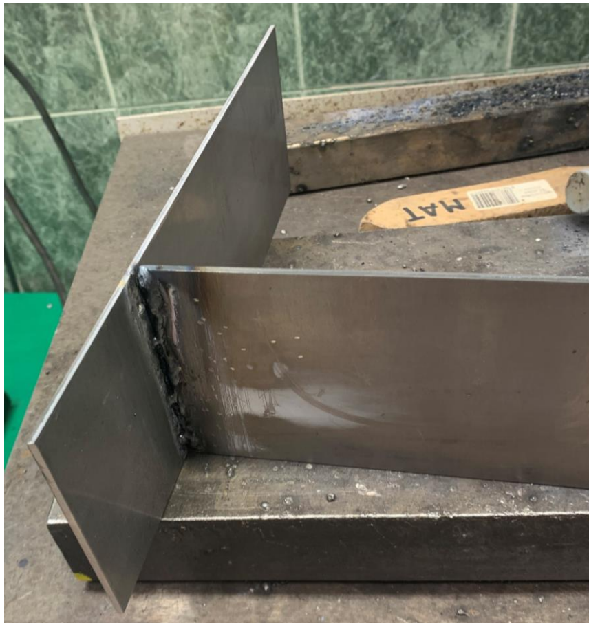
Ilustración 44: Resultado de la soldadura por electrodo revestido
