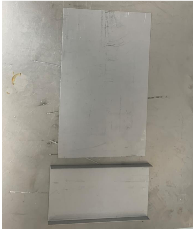
Ilustración 39: Piezas utilizadas para el proceso de soldadura
