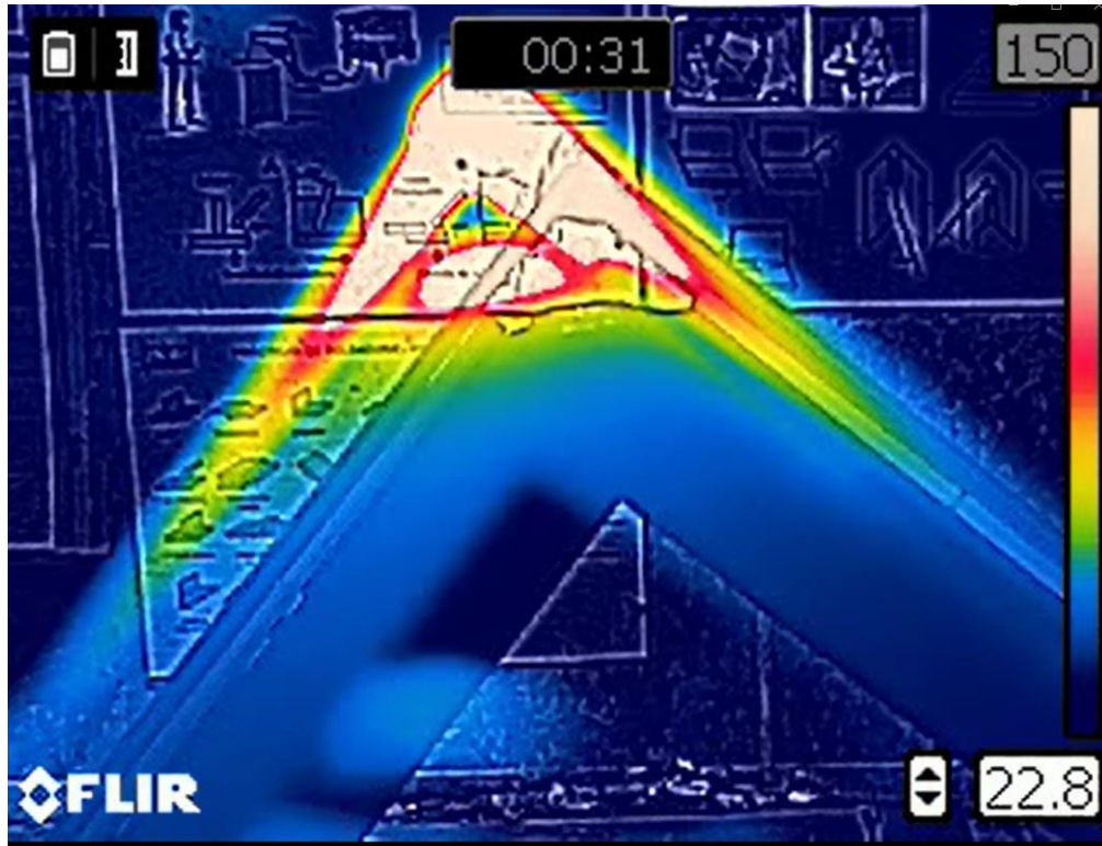
Ilustración 32: Ensayo térmico de un proceso de soldadura MIG
