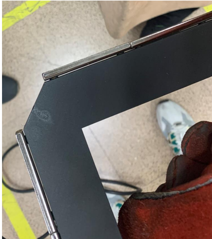
Ilustración 45: Escuadra magnética después del proceso de soldadura por electrodo revestido
