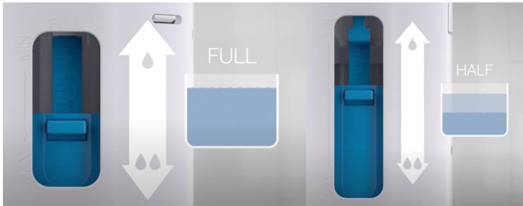
Ilustración 7.4: Tanques del descargador de la cisterna. Fuente: Vídeo de Roca
