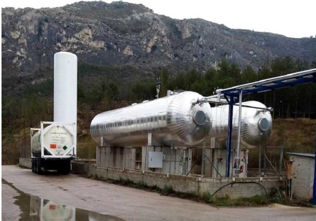
*Ilustración 13. Depósitos de CO<sub>2</sub> purificado pertenecientes a Carboneco, obtenido de una planta de cogeneración.
