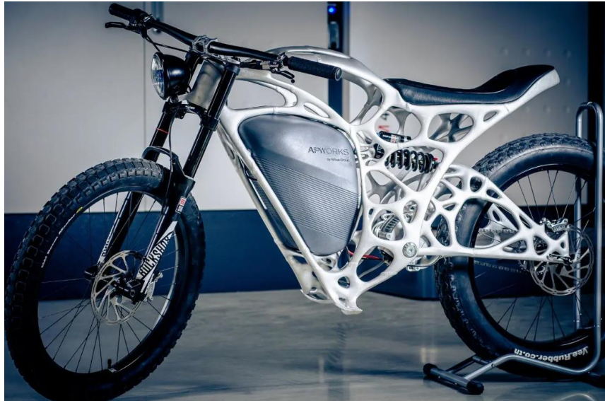
Figura 23. Chasis de moto tras OT (www.formlabs.com)
