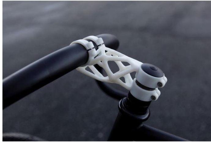
Figura 21. Ejemplo de pieza obtenida mediante OT (instructables.com)
