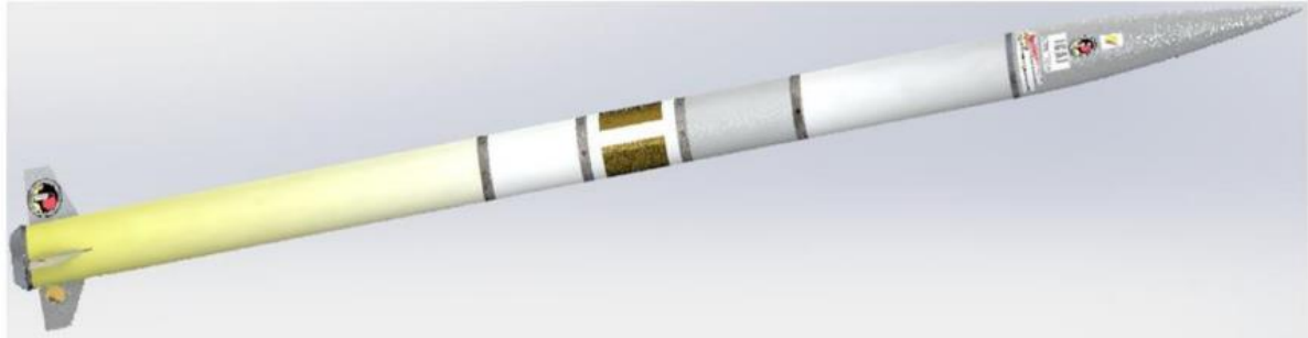
Aletas Módulo de motor y carga útil Módulo de aviónica Módulo de ajuste de longitud Módulo de recuperación Morro
