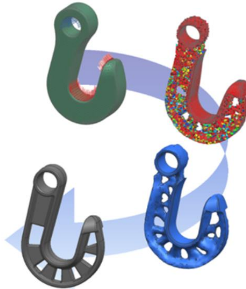
Figura 25. Aproximación de modelo de gancho tras OT ( www.iberisa.wordpress.com )
