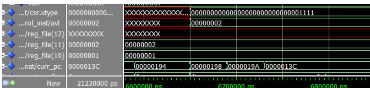
Figura 50. Simulación de la instrucción vsetvli.
