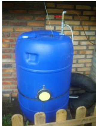
Ilustración 6. Diseño propuesto de biodigestor [3]
